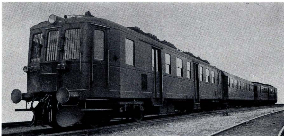
Fig. 288. Reserve 3-Vogns Lyntog, bestaaende af 2 dieselelektriske Motorvogne, Litra MO, med en mellem disse indkøbet 1. Kl. Personstaalvogn.
