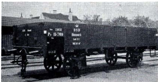
Fig. 328. Aaben Godsvogn Litra PF. Anskaffet i Aarene 1894—1916. Lasten, der oprindeligt var 12,5 Tons, er senere forøget til 15 Tons.
