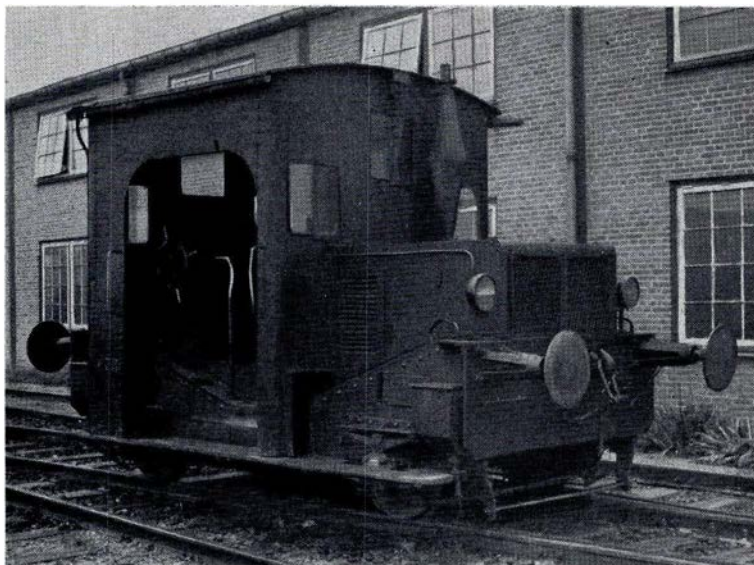
Fig. 293. Dieseltraktor fra Frichs, 60 HK. anskaffet i 1933.
